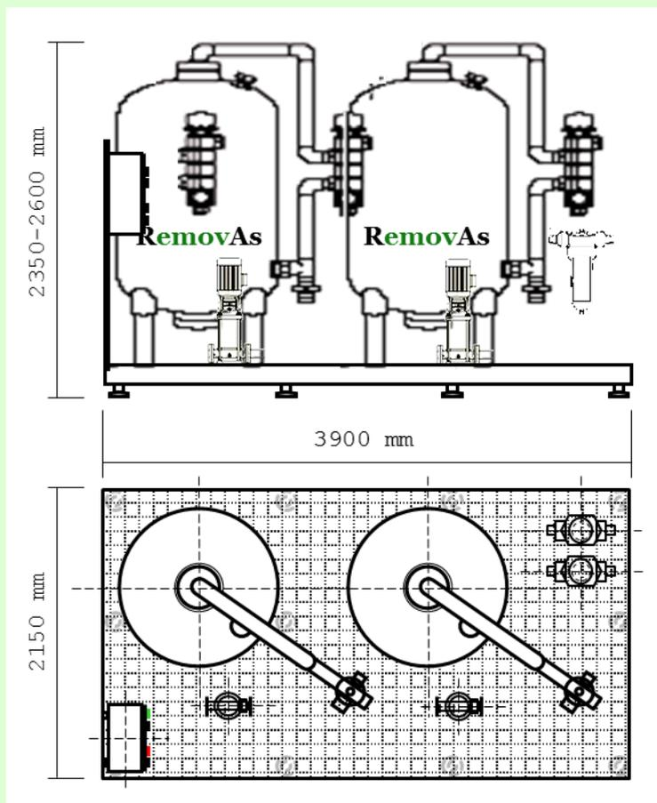
Ejemplo de equipo para 310.000 m<sup>3</sup> anuales, con 20 µg/L de arsénico en el agua de captación. Otras configuraciones y dimensiones posibles, en función de las necesidades.
